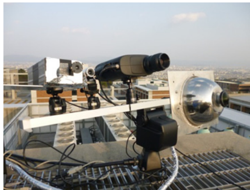
図5 魚眼カメラのXYZによる再構築の精度検証
