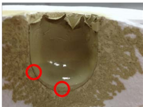
図3 通常のスリップキャスト(スラリーを静置する方法)で作製したグリーンボディの断面の写真
