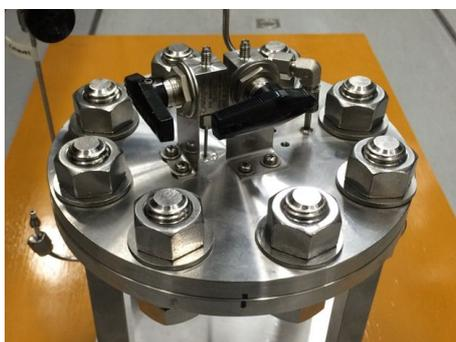
図 3 ガス透過セル
