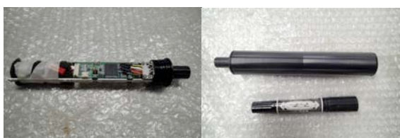
開発したペンシルサイズのデータローガー
