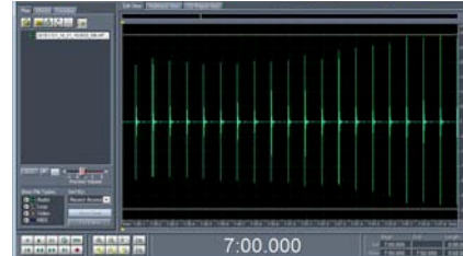
2016 年 11 月 21 日、ピンガーテスト記録波形（16：24：32～16：36：38 までの 12 分間）と拡大図
