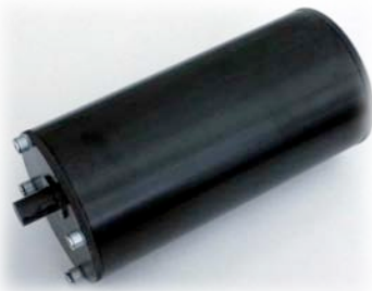
AUV 用に開発した水中音響雑音測定装置
