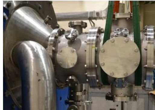
図5：本予算で製作した専用の真空容器と ETIGO-II への取り付けの様子。
