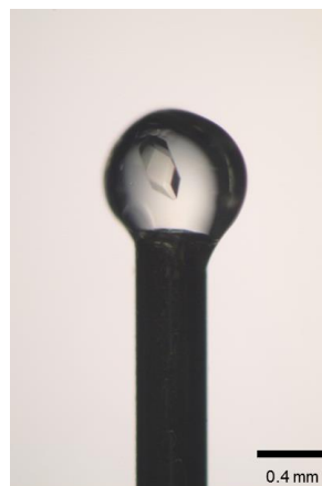
図 2. 回折実験のために、シリンジニードル先端でマウントしたタンパク質結晶含有ゲルカプセルの写真。
