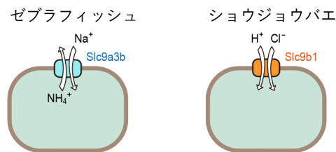
図3 Slc9 ファミリーの新たな活性。ゼブラフィッシュ Slc9a3b の Na^+/NH_4^+ 交換輸送活性およびショウジョウバエ Slc9b1 の H^+-Cl^- 共輸送活性。
