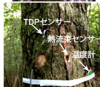
図2 二次林のコナラ・アバマキ樹幹へのセンサー類の装着
