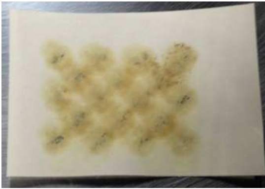
図4 気乾状態での熱分解試料 照射出力 110 W、照射時間 100 ms
