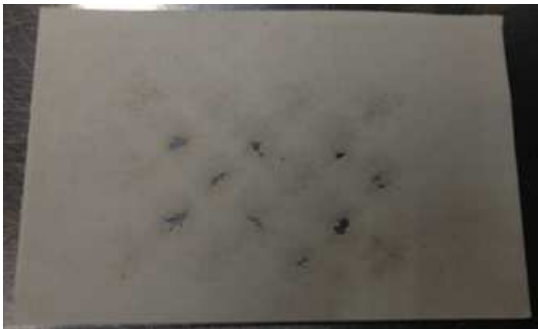
図5 湿潤状態での熱分解試料 照射出力 300 W、照射時間 100 ms
