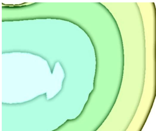
図4 カキ果実を不均質材料と仮定したことによる温度むらの発生(計算例)
