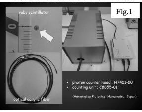
ム (H7421+C9744)を使用した。光ファイバーはフォトンカウンティングシステムに専用のコネクタを用いて接続し、フォトンカウンティングシステムは持ち運びが可能なケースに固定した状態で使用した。開発したシステムの外観を Fig.1 に示す。
