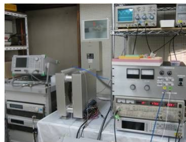
図 4 ラピッドスキャン機能を備えた EPR イメージング装置 (藤井研究室で稼働中)
