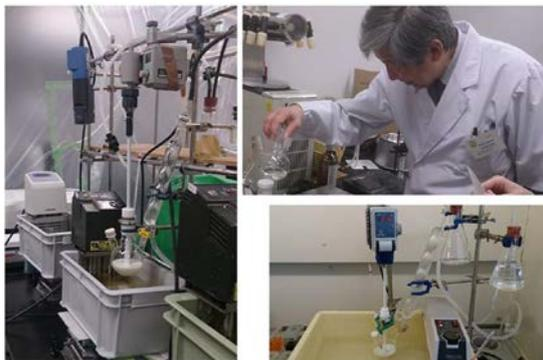
4種類のモノマーをアルコールで溶解し、開始剤を加えて60℃、200rpmで6時間攪拌する。フラスコ内の空気は、窒素に置換する。攪拌が終了したのち、遠心分離し、アルコールを水に置き換えて高分子ゲルが完成する。作成した高分子ゲルに免疫染色を行ない、ゲル粒子の大きさ、染色性の評価を行なった。
