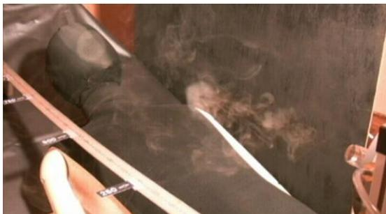
火災事故予防の観点から、本実験では、二酸化炭素を使用したので、放出部の高さの軸線よりも二酸化炭素の比重で落ちることによる計測濃度の低下を考慮する必要がある。酸素を使用した実験の場合、今回の結果よりも、到達濃度は維持される可能性がある。
