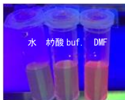
図 4 ヘマトポルフィリン色素結合した真球状酸化チタン粒子ハイブリッド体の蛍光観察
