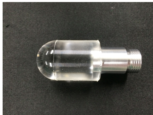
Fig.1: 透明シリコンを用いた柔軟指接触センサ
