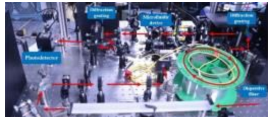
図1: タイムストレッチ顕微鏡 (a) 概略図 (b) 実際の実験装置
