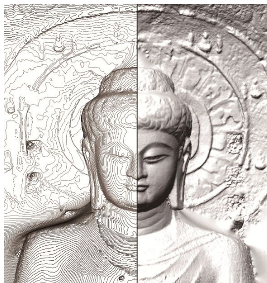
図3 龍門像を等高線図(左)、正投影図(右)で示したもの。
