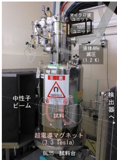
図3. 核スピン偏極実験装置
