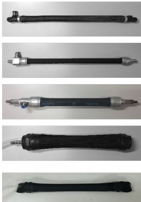
図 4:本研究で同定対象の人工筋製品 5 種(上から,ActiveLink 社 10mm, 0.25m, FESTO 社, 10mm, 0.25m, FESTO 社, 20mm, 0.20m, 神田通信工業社 1.25inch, 0.20m, 神田通信工業社 0.5inch, 0.17m. 数値は,それぞれ,人工筋の直径と長さ.)
