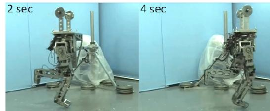
図10 着地位置変更による走行速度制御
