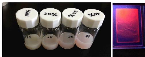
図-3 発光粒子懸濁液と成膜した紫外光照射下の膜発光画像
