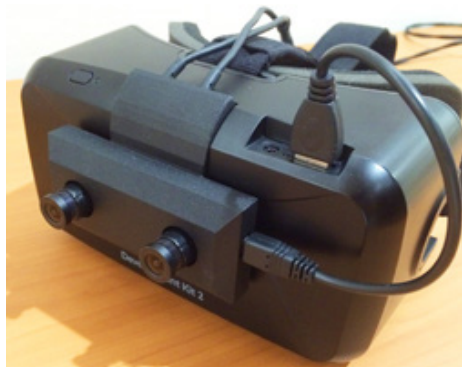
図8 使用したヘッドマウントディスプレイ(Oculus Rift DK2)。外部映像の取得用に、ステレオカメラ(OVRVision)を機器前面に装着した。
