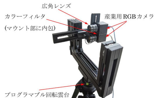
図1 構築した計測システム
