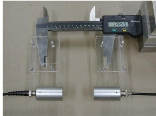
図1 送信・受信用の振動子を対向させた計測システム。
