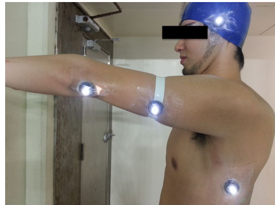
図 1. 本研究で使用した LED マーカーとその貼付方法の写真
