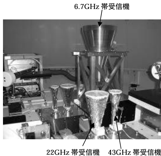
図2 VERA 20m鏡内部の受信機の配置
