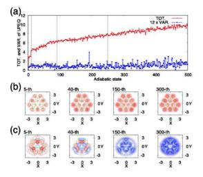
高擬縮重電子励起状態群の区別を行った。 不対電子量が電子状態の高さに正相関し増大する事(aの赤:不対電子量,b:その空間分布)、 不対電子密度の結合次数成分を空間表示する とその正負分布に励起状態の高低が反映され る事(b)を見出した。
