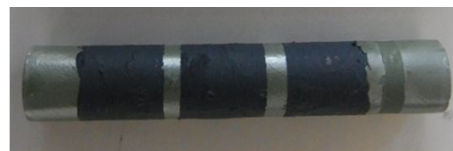
図2 空気極分割セル
