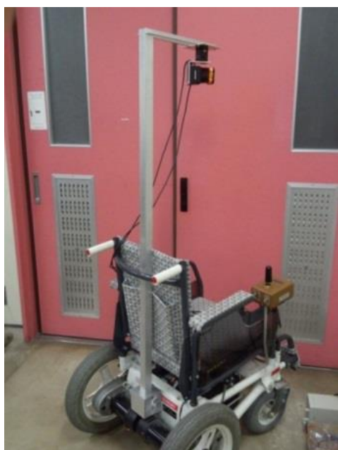
図4 レーザレンジセンサを搭載した車いす
