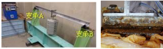
(a) 梁模型実験の様子
