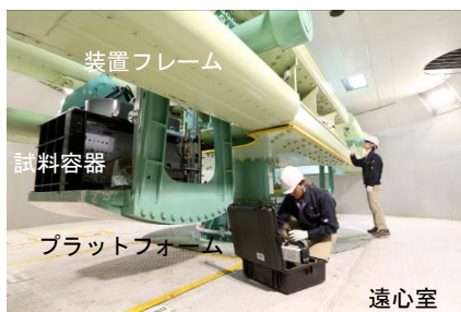
図3 使用した遠心模型実験装置
