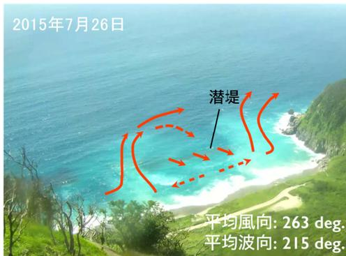
図-5 和田浜海岸沖合の海浜流の形成パターン
