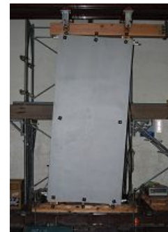
写真5 1Pモルタル外壁実験の状況
