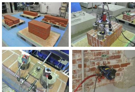
図7 アンカーボルトの各種強度試験の様子
