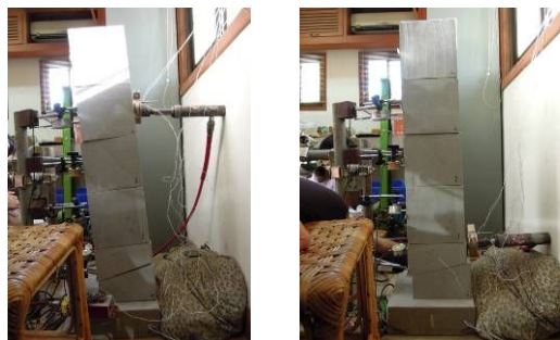
図3 石積みの水平載荷試験時の転倒モード(左)と滑りモード(右)の様子
