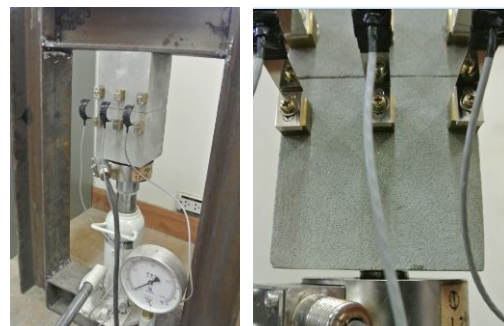
図2 石積みの不連続面の圧縮試験
