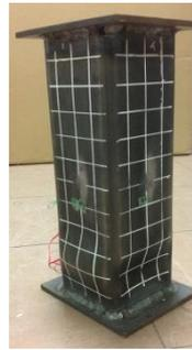
Fig. 3 座屈形状の例
