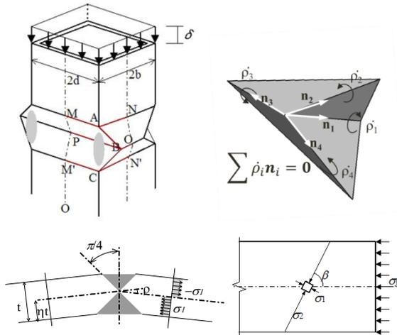
Fig. 1 降伏線解法に適用した仮定
