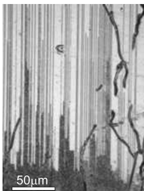
図5 種子結晶から成長させた周期双晶。
