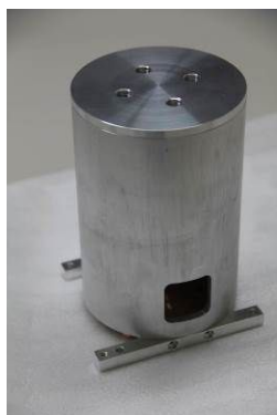
図4 設計と作製した温度可変のその場時分割X線反射率測定用電気化学セルの写真。
