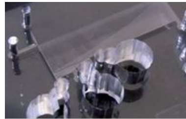
図2 PDMSで作成したデバイス (Migita et al., Anal. Methods から引用、一部改変)
