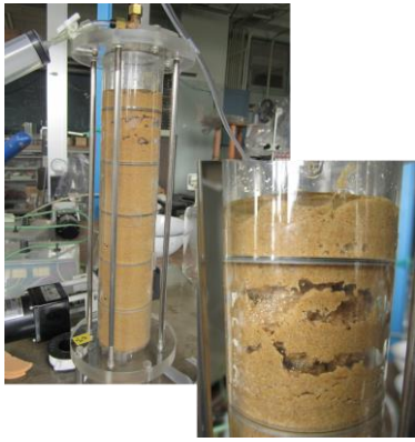
図4 小型模型土中に生成した亀裂の様子
