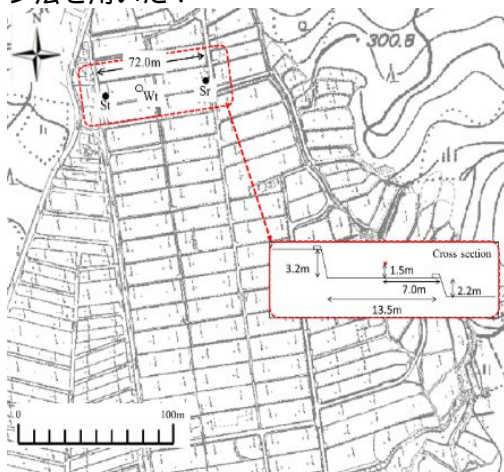
図 3 微気象観測機器の設置概要
