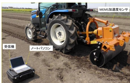
図 3 振動加速度の測定風景
