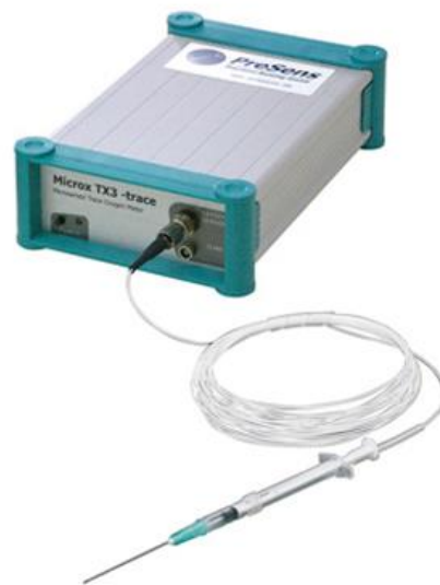
図1 ニードル式のマイクロ酸素濃度計 (タイテック社製、Microx TX-3, ニードル外径 0.4mm、センサ系 0.14mm)
