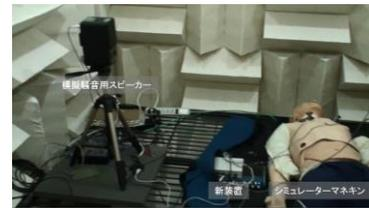
騒音計は人形の胸壁上約35cmの高さで測定した。一般的に騒音の目安としてファミリーレストラン、銀行窓口(60dB)、バス、新幹線車内、主要幹線道路周辺(70dB)、航空機の機内(80dB)、パチンコ店内(90dB)であり(騒音の目安、全国環境研会誌 vol. 34, No. 4)、これらの騒音レベルを参考とした。新装置の記録データは従来装置と同様に16bit, 48kHzで量子化され、wave形式(拡張子 wav.)ファイルに保存される。そのファイルを、周波数解析ソフトであるリアルタイムアナライザ ver. 5(吉正電子)を用いて、吸気時(ピークフロー時)の、5サイクル分の周波数毎の音圧(単位 dB デシベル)を抽出し平均化したものを、左右で比較した。事前の研究から8dBの差があるもの(カットオフ)を“気胸あり”とした(図5)。
