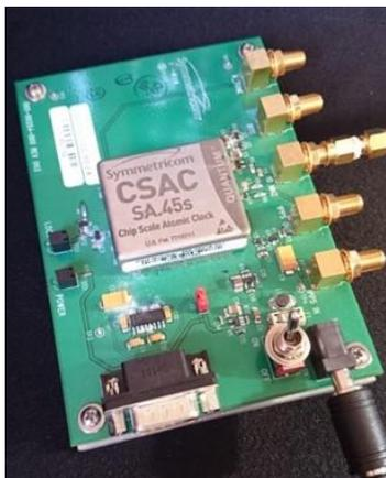
図 5 CSAC 社製小型原子時計
