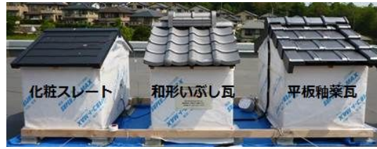
図3 屋根模型外観
