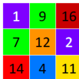
図 2 提案法により求めた病理画像用 MSFA (観測波長は 1: 424nm, 2: 448nm, 4: 482nm, 7: 535nm, 9: 566nm, 11: 602nm, 12: 622nm, 14: 666nm, 16: 720nm.)。
