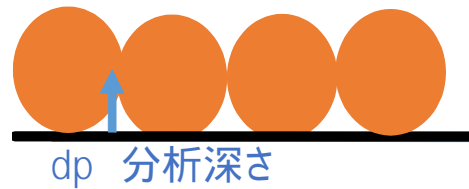
図1 界面上に並んだ PSNP と dp を変えることによる深さ依存測定。特定面を制御された凹凸が形成される。
