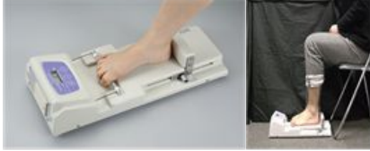
図1 足趾筋力測定器と足趾握力測定方法
