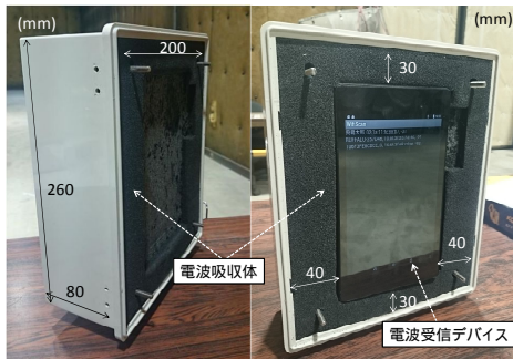
図-6 電波吸収体とデバイス設置状況
