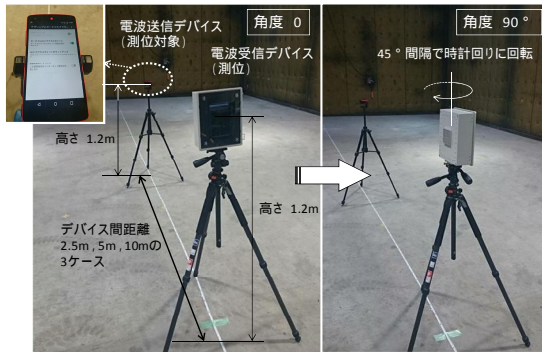
図-5 通信電波強度計測実験状況
